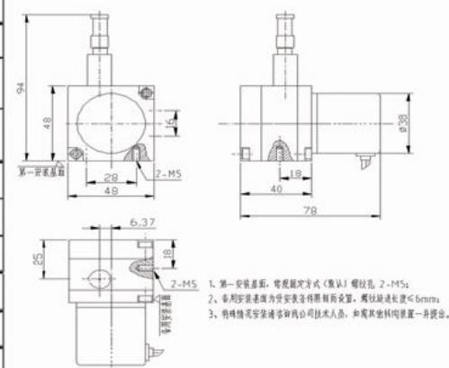
1. 第一安装基底，需根据方式《集成》螺纹孔 2-M5；
